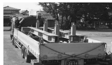
鉄骨ユニック輸送
