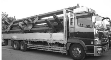
鉄骨柱 10m 輸送
